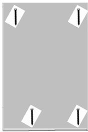
6. Deite o caixote superior de frente. Posicione o traseiro superior sobre as costas. Alinhe o canto superior esquerdo a 2mm de distância da base e da lateral. Coloque 2 pregos 10x10 para fixar em cada extremidade. Alinhe a outra extremidade e pregue da mesma forma.
