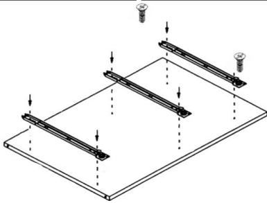
2. Parafuse os pezinhos, 2 em cada extremidade inferior (lado oposto ao das cavilhas). Use os parafusos 3,5x14. Deixe uma distância de 5cm de cada ponta;
